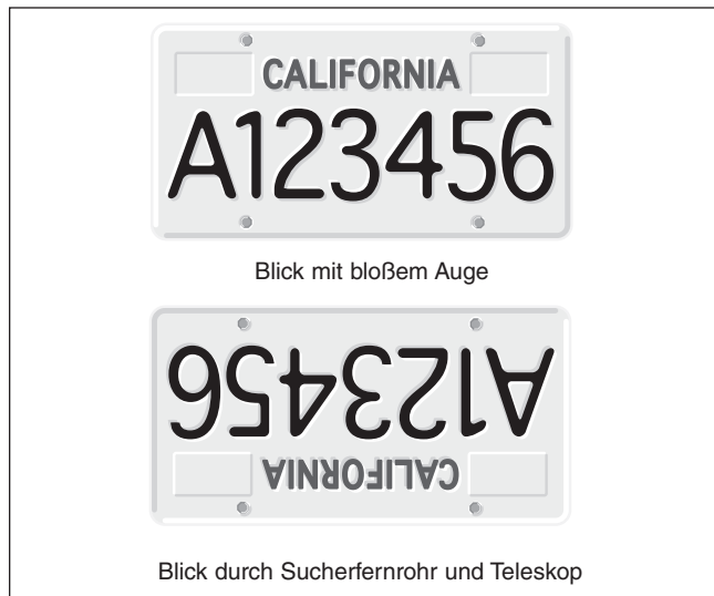
Abbildung 5. Beim Blick durch ein Standard-Sucherfernrohr oder Spiegelteleskop steht das sichtbare Bild auf dem Kopf. Dies gilt auch für das SpaceProbe 130ST-Teleskop und sein Sucherfernrohr.
