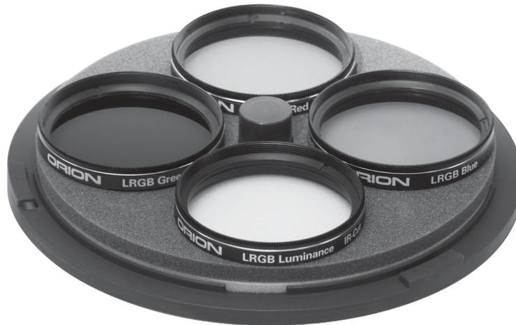
Das Orion 2 "LRGB-Bildfilter-Set enthält Luminanz- (L), Rot- (R), Grün- (G) und Blau- (B) Filter, mit denen Sie bei Verwendung einer Schwarzweiß-Bildgebung atemberaubende zusammengesetzte Farbbilder von Nachthimmelobjekten erstellen können. Jeder Filter bietet eine freie Blende von 43,2 mm, was für großformatige CCD-Kameras geeignet ist.
