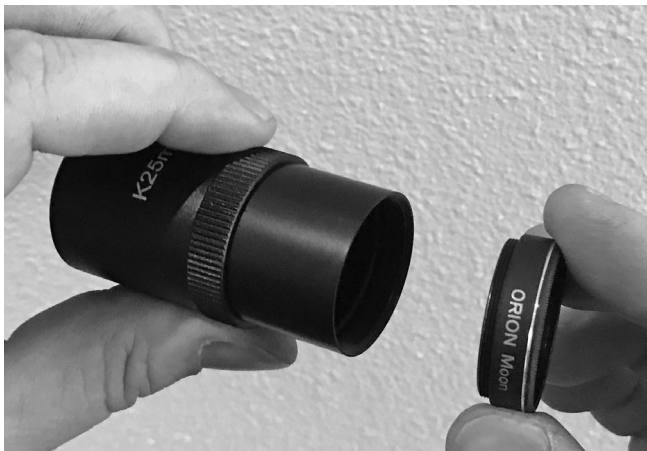
Abbildung 21. Die Steckhülse der Kellner-Okulare sind mit Gewinde versehen, in die separat erhältliche 1,25" (32 mm) Orion-Filter passen. Ein Mondfilter ist nützlich, um Blendung zu reduzieren und so mehr Details auf der Mondoberfläche zu zeigen.
