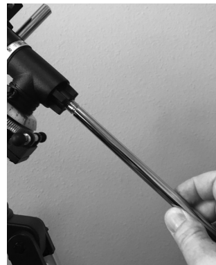
Abbildung 9. Schrauben Sie die Gegengewichtsstange in das Gehäuse auf der Dek-Achse ein.
